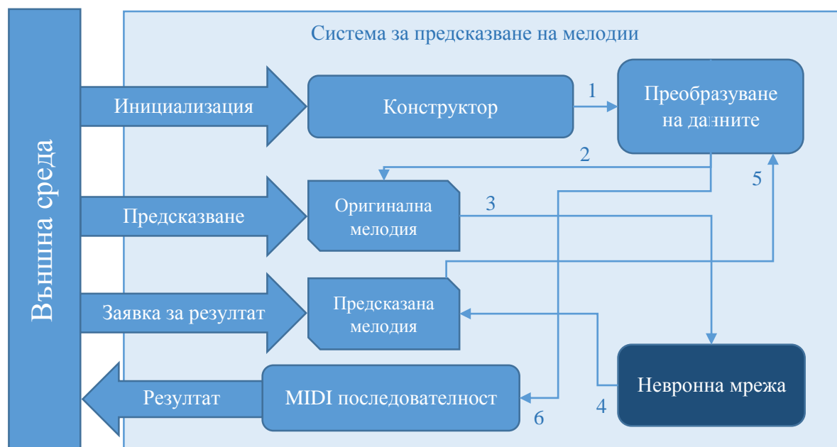
Фигура 15. Принцип на действие на системата за предсказване на мелодии
