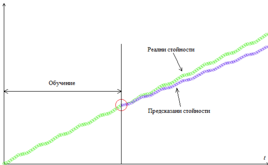
Фигура 8. Тестване на точността на предсказване на времеви серии от невронна мрежа с обратно разпространение на грешката
